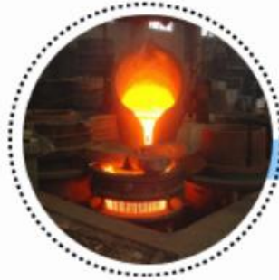
Pouring cylinder body
